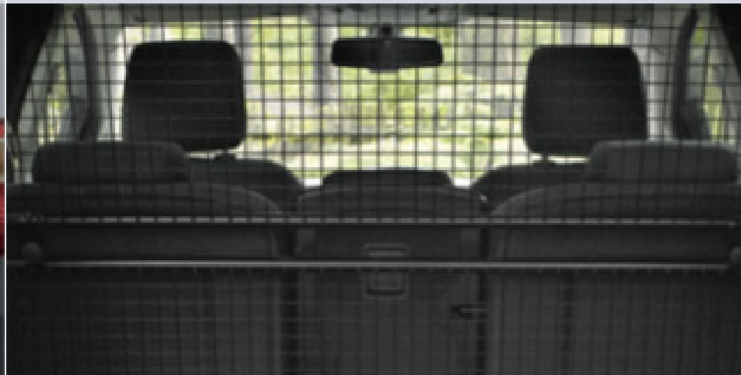
Paroi de séparation pour le compartiment de chargement, mi-hauteur
